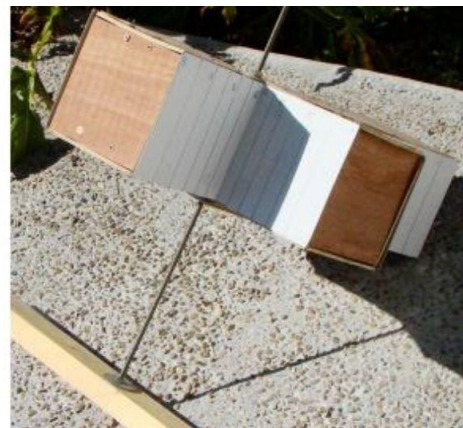
La croix et la maquette d'un bloc gnomonique en croix de même dimension avec ses lignes horaires
