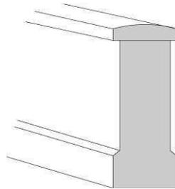
**Mur pignon** : Il s'agit d'un mur extérieur d'une construction, souvent latéral, dont la partie supérieure résulte généralement de l'élévation des plans inclinés des versants de la toiture au-dessus des lignes sablières.
