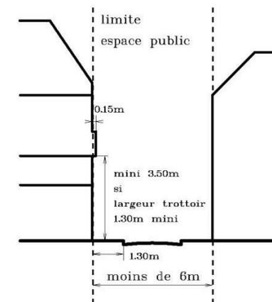
4. Dans tous les cas les grands balcons devront être placés à 4,30 m au-dessus du sol, à moins qu'il n'existe un trottoir d'une largeur jamais inférieure à 1,30 m au moins, auquel cas la hauteur de 4,30 m ne pourra être inférieure à 3,50 m. Ceci conformément aux dispositions de l'arrêté du 30 mars 1967 relatif à la refonte de l'instruction générale sur le service des chemins départementaux.
