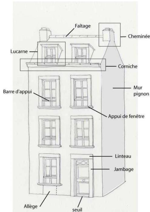
**Corniche** : Moulure horizontale au haut d'un piédestal, d'une porte, d'une fenêtre ou d'un mur de bâtiment qu'elle raccorde au plafond en garnissant l'angle qu'ils forment entre eux. La corniche peut être aussi l'une des parties de l'entablement constitué par l'ensemble des moulures en saillie formant le couronnement d'un édifice.
