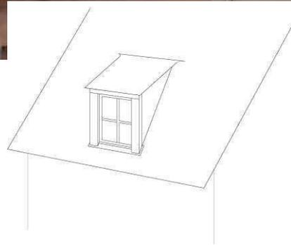
Il s'agit d'une lucarne couverte par une toiture inclinée dans le même sens que le versant du toit.
