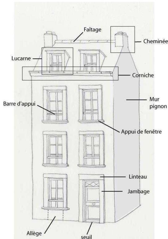
**Appui de fenêtre** : Partie inférieure une baie, sur laquelle repose la croisée ou le bloc baie
