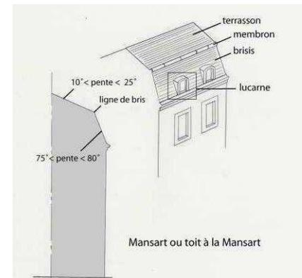
**Brisis** : Partie inférieure d'un versant de comble brisé à la Mansart, au-dessous de la ligne de bris. Etage mansardé compris entre l'entablement d'un comble et la ligne de bris.
